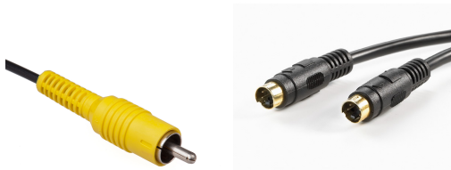
Figure 2.18: Konzumer alkalmazásokhoz használt sárga jelölésű RCA csatlakozó (a) és a luma-QAM chroma jeleket külön érpáron átvivő S-videó csatlakozó (b)
