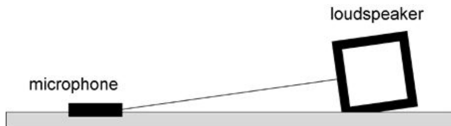
3.9. ábra: A mérési elrendezés illusztrációja: A hangszóró főiránya rá van irányítva a földre helyezett mikrofonra [19]
