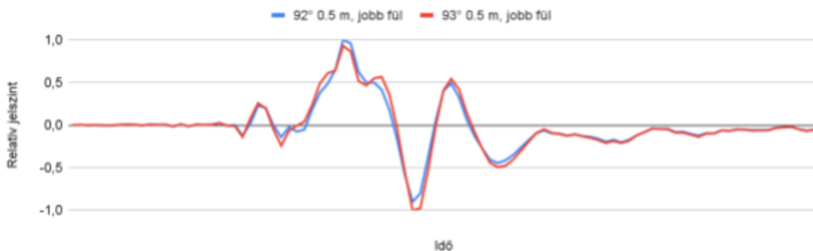
3.4. diagram: Az impulzuscsúcsokra hagyatkozó késleltetésszámítás hibájának oka.
