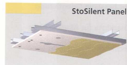
Fugenloses Akustikplattensystem mit rauer Schlussbeschichtung
