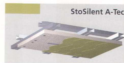
Fugenloses nichtbrennbares Akustikplattensystem mit rauer Schlussbeschichtung
