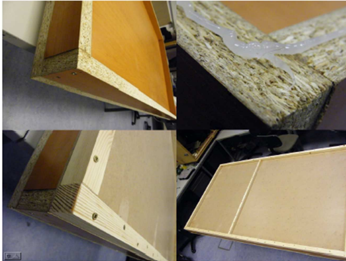
17. ábra: A membránrezonátor összeszerelése
