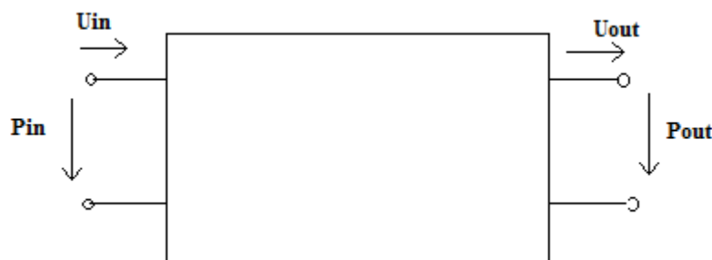
2.9. ábra A távvezetéksz szakasz kétkapu ábrázolása
