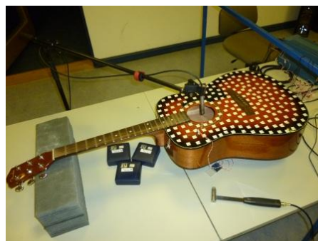
(b) A fedlap mérése
