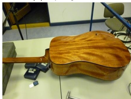
(d) A hátlap gyorsulásérzékelője
