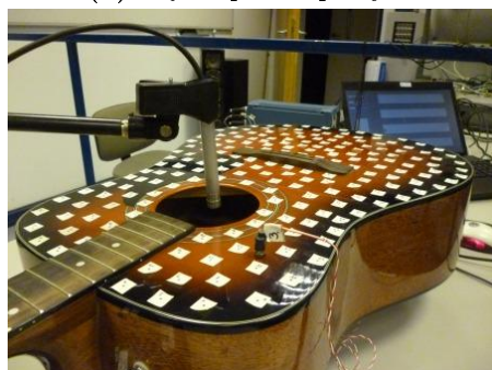
(c) A fedlap gyorsulásérzékelője
