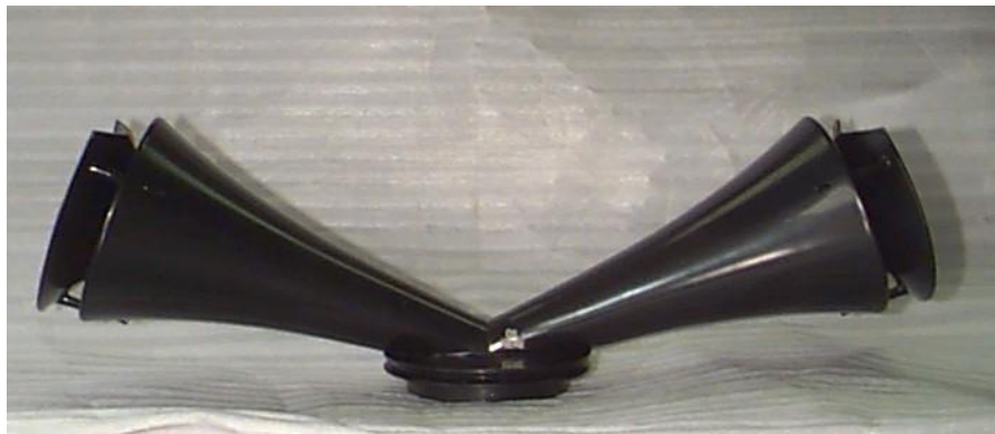
5.8. ábra: A modellezett tölcsérpár [K6]
