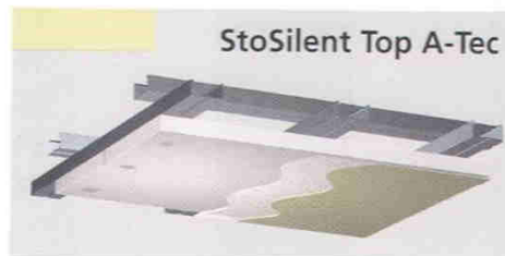
Fugenloses nichtbrennbares Akustikplattensystem mit feiner Schlussbeschichtung
