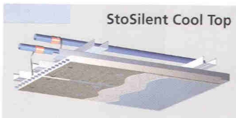
Fugenloses Akustikplattensystem mit Kühl- und Heizfunktion, feine Oberfläche
