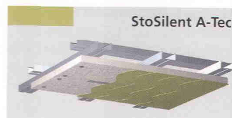
Fugenloses nichtbrennbares Akustikplattensystem mit rauer Schlussbeschichtung
