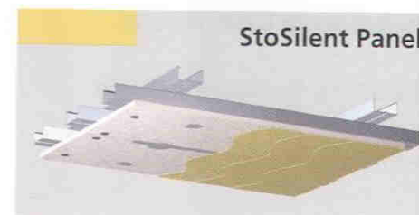
Fugenloses Akustikplattensystem mit rauer Schlussbeschichtung
