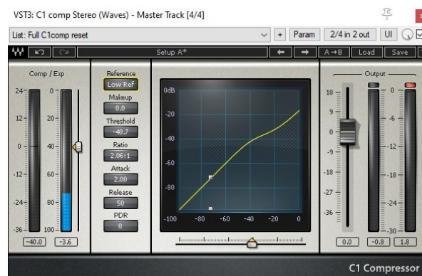
8.2. ábra Waves plugin threshold és ratio ábrázolása
