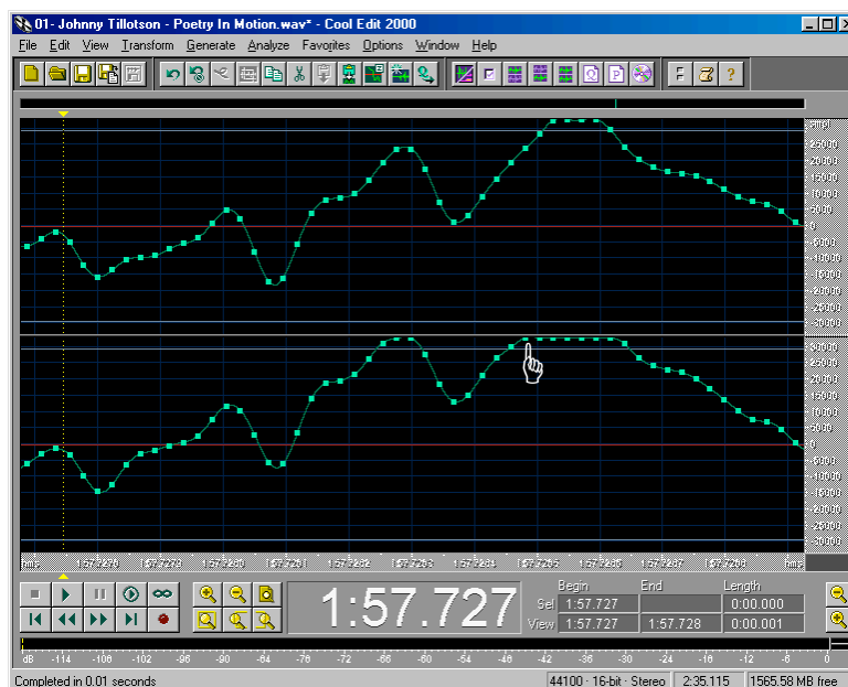
2.7. ábra. Hullámforma szerkesztés „kézi tologatással”
