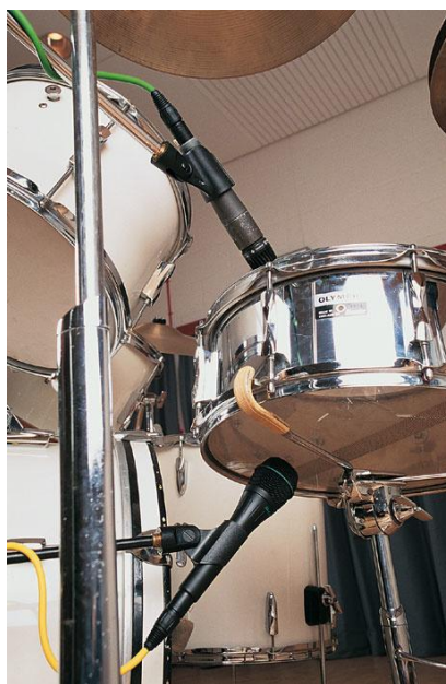
12. ábra: Pergődob rögzítése két mikrofonnal [17]
