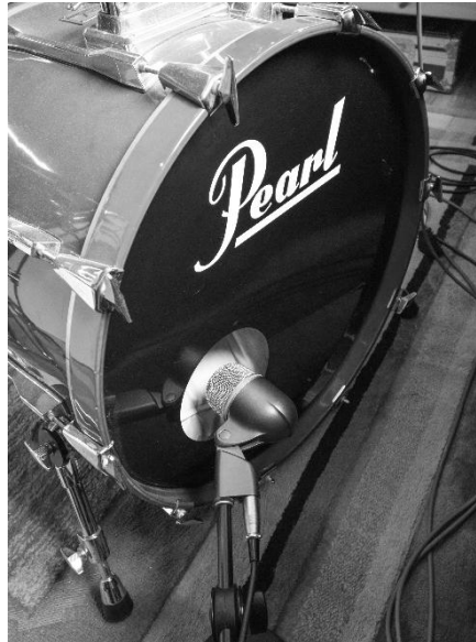
24. ábra: A lábdobmikrofon elhelyezése
