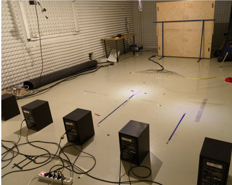
8.3. ábra. Reflektív mérési elrendezés a gyakorlatban
